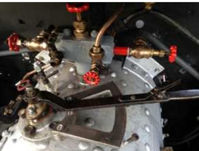
Puis, fin Octobre : Pose des appareils dans la cabine : il faut tout retrouver chez des collectionneurs et dans notre stock de pièces. Le reste est fabriqué par nous même.
