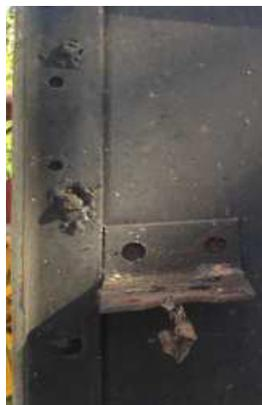
Les rivets ne sont que des trompes l'œil soudés au dos et les soudures dégoulinent sur la carrosserie....
