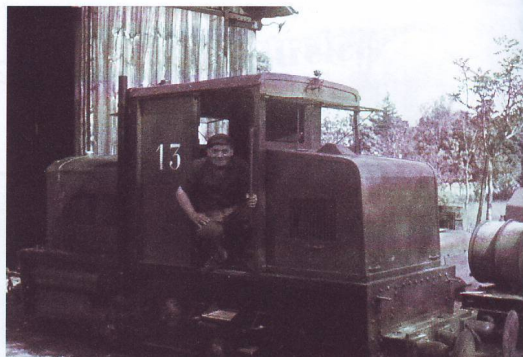
▲ Un locotracteur Billard n°13 aux attelages adaptés pour remorquer les Girafes. Photo de J.-J. Doërlinger.
