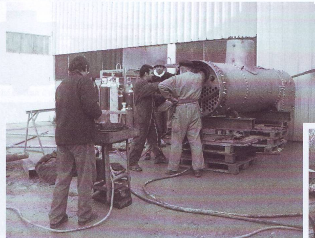
Jo, Guillaume, Patrick et Marc font le rivetage de la plaque tubulaire. Un marinier, un membre de l'AJECTA, deux du Tacot des Lacs : une belle marque de fraternité autour de Felin Hen. 2008. Photo de Eric Sauvage
